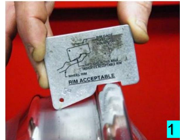
Wenn vorhanden Grat am Felgenhorn sowie Korrosion entfernen
