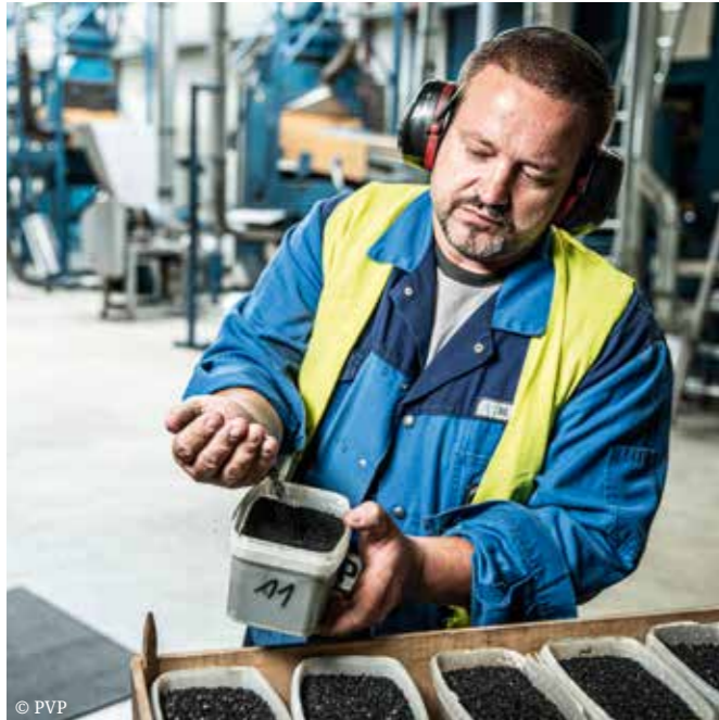
Täglich wird das erzeugte Gummigranulat einer intensiven Qualitätsprüfung unterzogen. Dazu gehört auch die Sichtprüfung von Stichproben aus der aktuellen Produktion.
