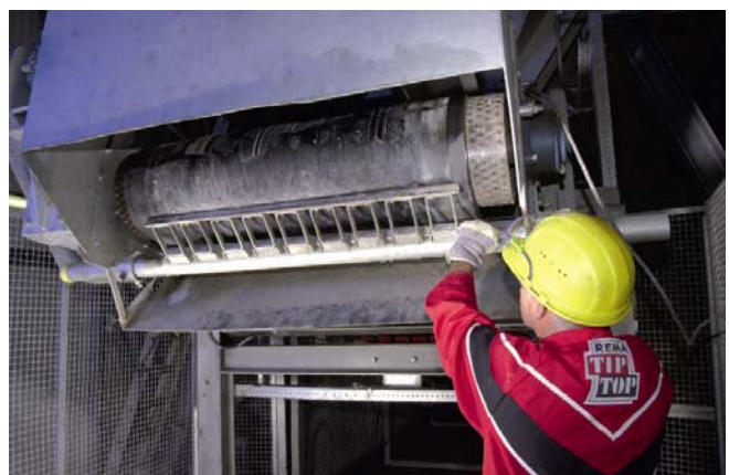
Abbildung 6: Montage eines Gurtreinigungssystems
