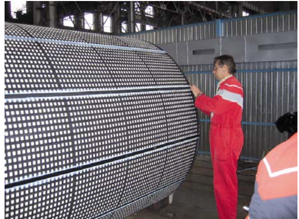
Abbildung 3: Applikation eines Keramik-Gummi-Trommelbelags
