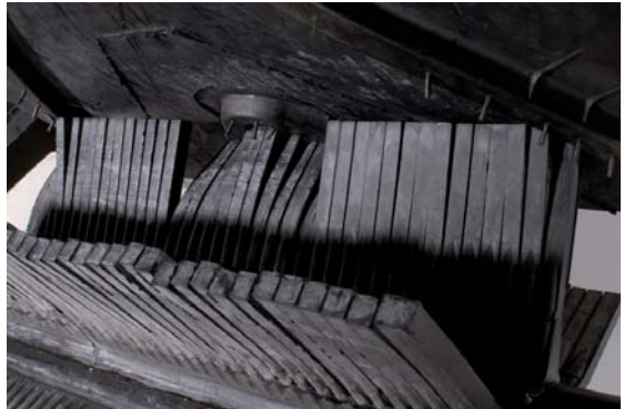
Abbildung 7: Reinigungssystem für Steilfördergurte (Chevron Belts)
